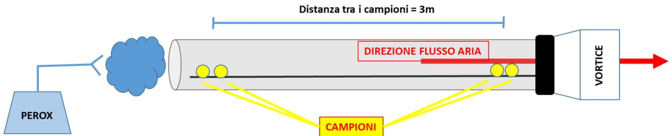
L'erogazione della miscela di Perox ha avuto una durata totale di 2 minuti ed è stata condotta impostando il flusso della macchina a 0.2 L/min.
